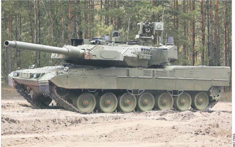
System obrony aktywnej Trophy. Na zdjęciu w wersji zamontowanej na czołgu Leopard 2
